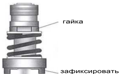
Рис.1. Устройство предохранительное храповое
